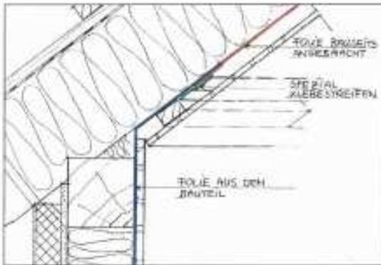
überlappt und der Stoß mit dem Spezialklebeband verklebt (siehe Skizzen).
